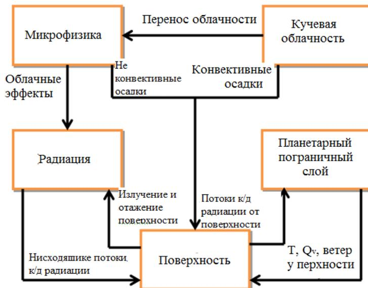
Рисунок 2.5 –Блок-схема процессов, которые требуют параметризации в модели WRF
