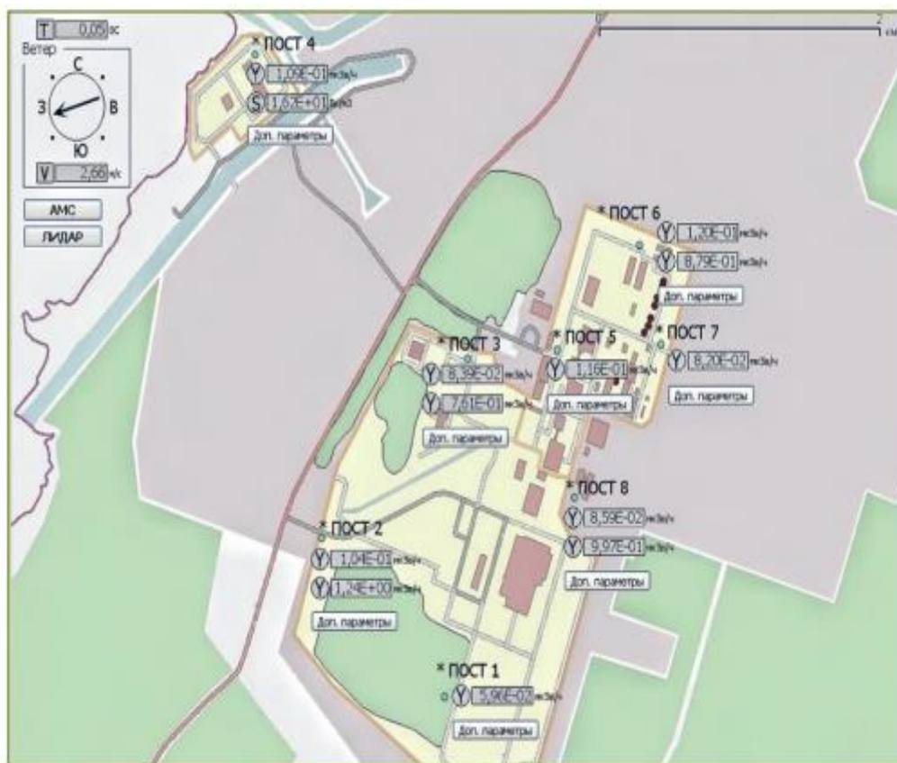
Рисунок 1.5 – Схема размещения постов автоматического радиационного контроля на площадке НИТИ
