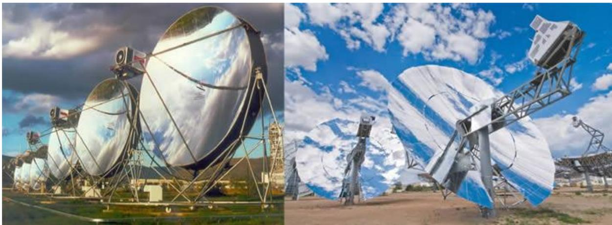
Рисунок 44 - Солнечные электростанции (СЭС) с использованием двигателя Стирлинга
