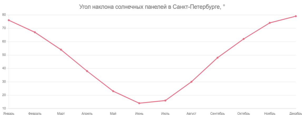
Рисунок 18 - Оптимальный угол наклона солнечных панелей в Санкт – Петербурге в зависимости от месяца[2]
