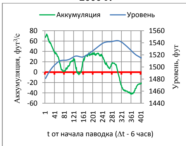
Рисунок 3.18 – Графики хода уровней (в футах) и расхода аккумуляции в верхнем бьефе водохранилища Тарбела (в тыс. футов 3 /с) за период с 15 июня по 30 сентября (скользящее среднее при ширине окна 7 суток).
