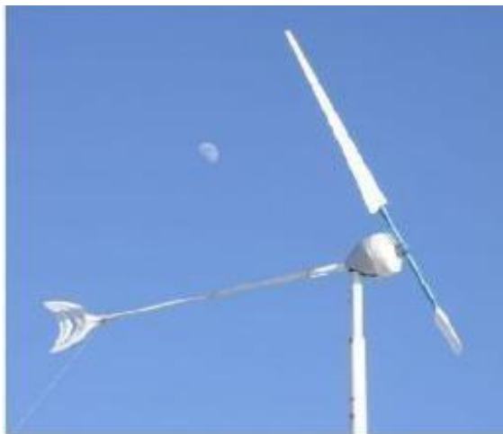
Рисунок 3.9 –Однолопастный ветрогенератор с противовесом
