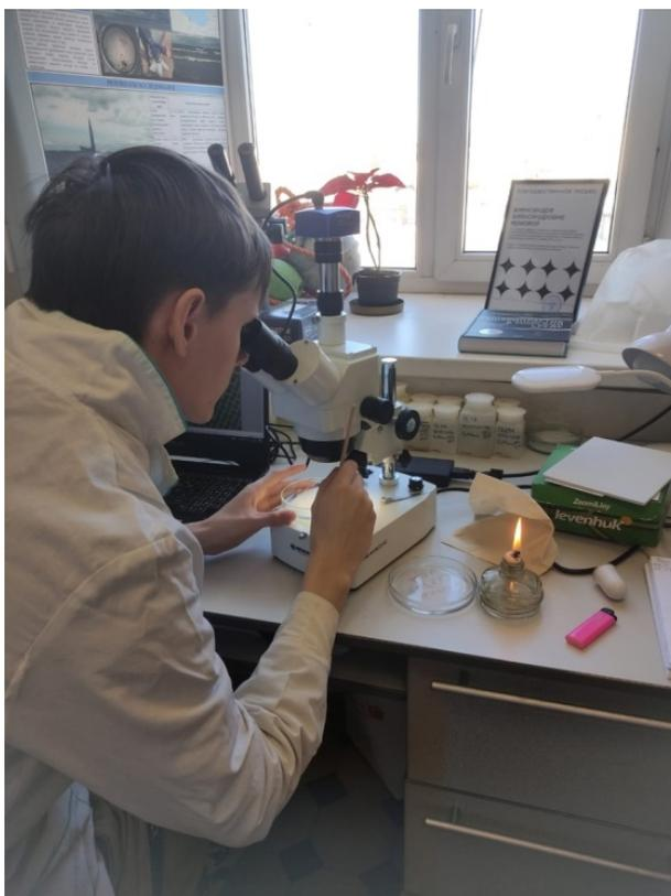
Рисунок 4 – Проверка частицы горячей иглой при идентификации микропластика в ходе работы со световым микроскопом Bresser в лаборатории ПластикЛаб.
