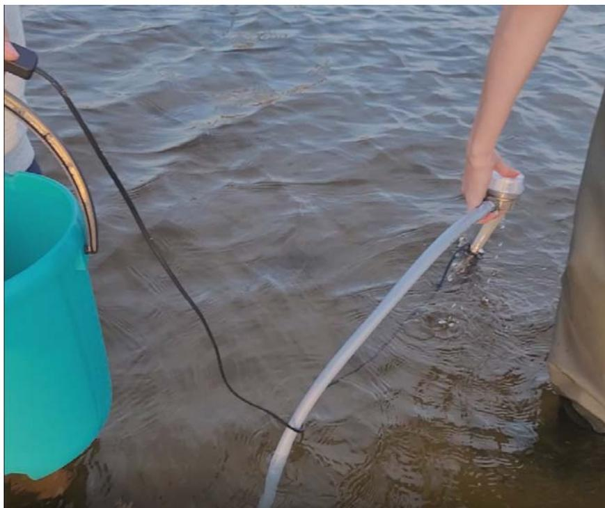
Рисунок 3 – Работа с пробоотборной системой «HydroPUMP» летом 2022 года в Невской губе.
