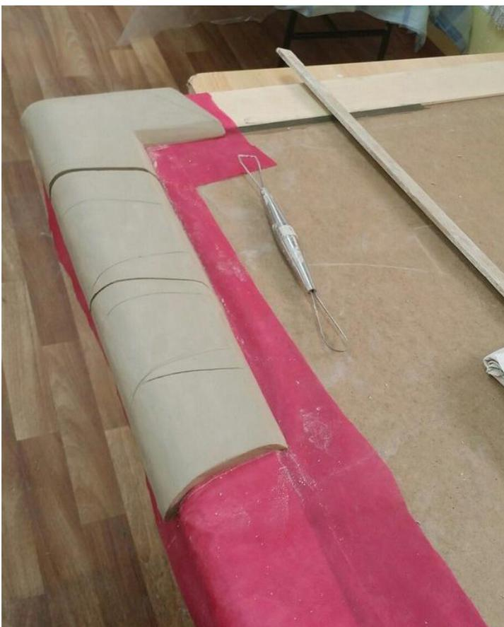
Рис. 27 Отминка керамических пластов
