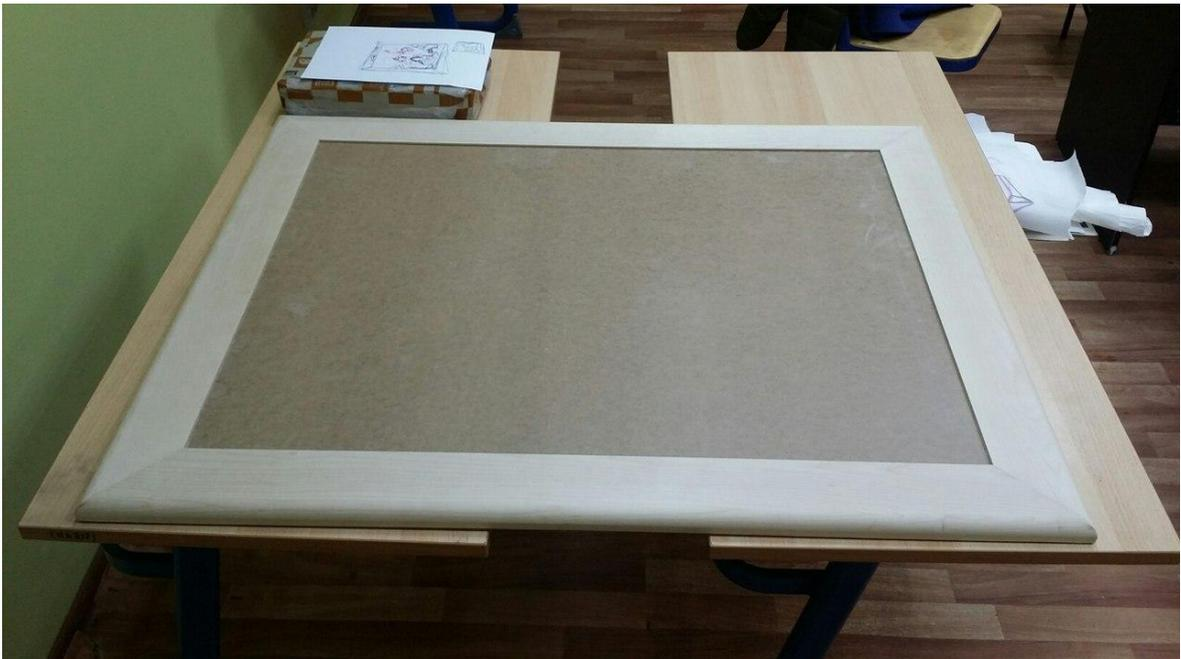
Рис.23 Рама – каркас из березового бруса
