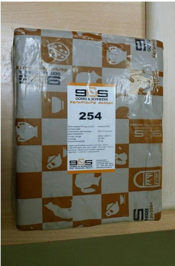
Рис.26 Мелкошамотная немецкая глина фирмы «Georg&Schneider»
