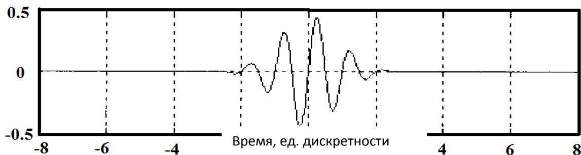
Рисунок 2.3. Комплексный вейвлет Морле [24]: а) вещественная часть; б) мнимая часть
