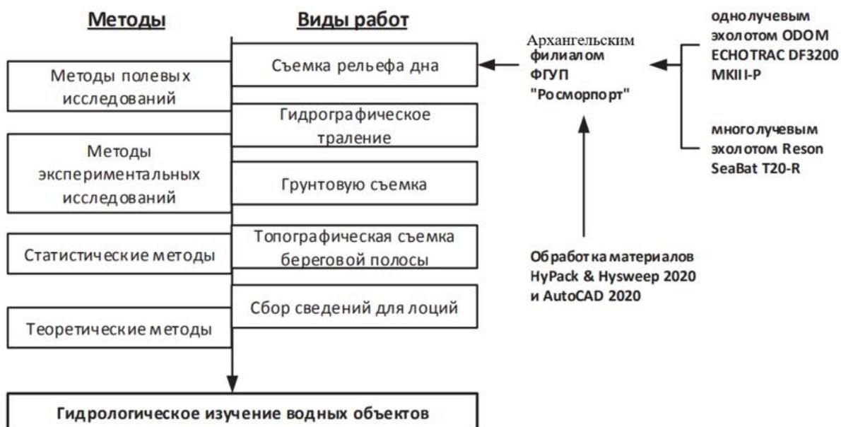
Рисунок 8. Методы и виды гидрографических работ
