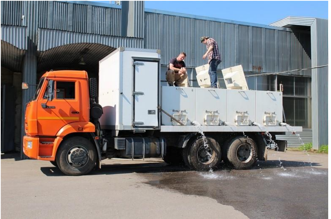
Рис. 9. Живорыбный автотранспорт на шасси КАМАЗ 65115 [82].
