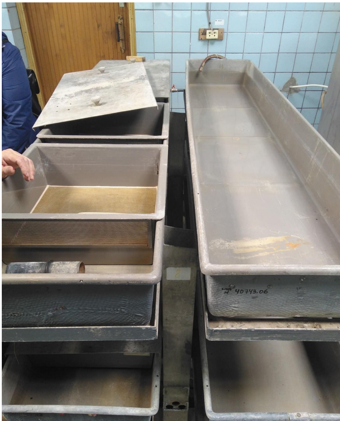
Рис. 7. Горизонтальные лотковые аппараты шведского типа. Фото из архива автора.
