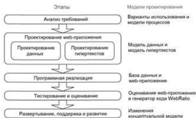
Рисунок 2.1. Этапы модели разработки WebML
