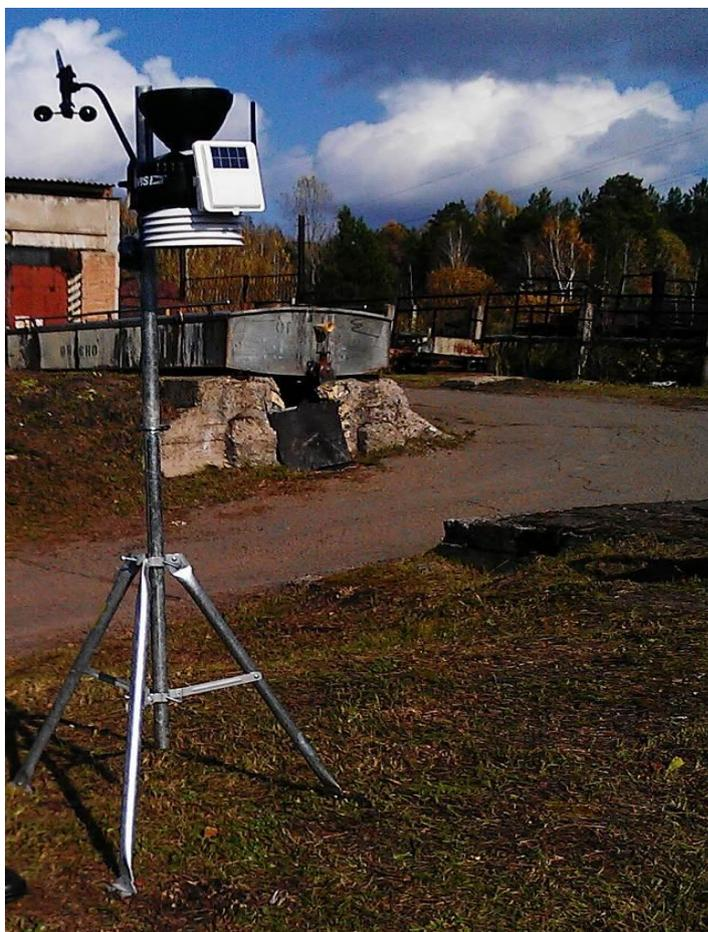
Рисунок 2.2.1 – Установленная метеостанция DAVIS Instruments Vantage Pro2 6152EU. Общий вид.
