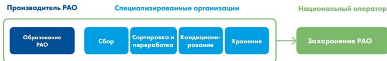
Рис. 24. Общая схема обращения с радиоактивными отходами [77, с. 5]
