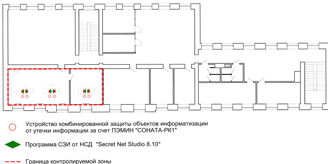
Рисунок 29 – Схема рекомендуемого расположения средств защиты информации
