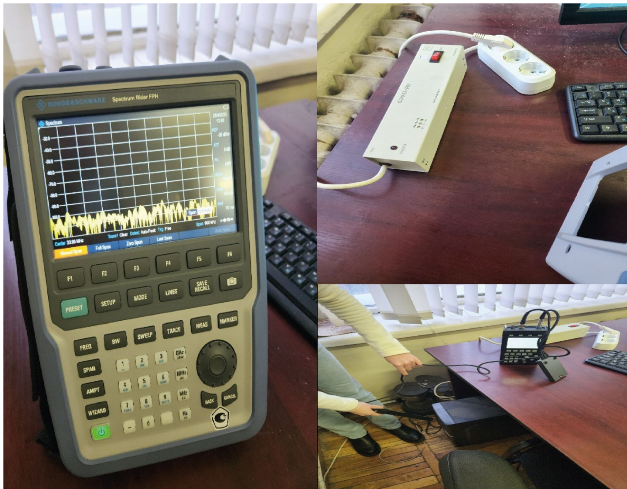
Рисунок 27 – Практическое выполнение измерений ПЭМИН с применением технического средства защиты информации «СОНАТА – РК1»
