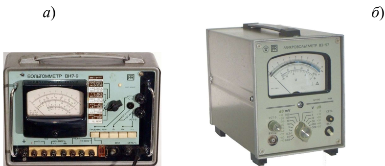
Рис. 5.2 Электронный вольтметр ВК7-9 (а); ВЗ – 57 (б)
