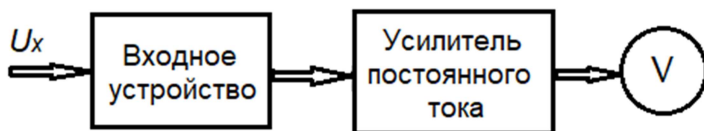
Рис. 5.1 Структурная схема электронного вольтметра постоянного тока
