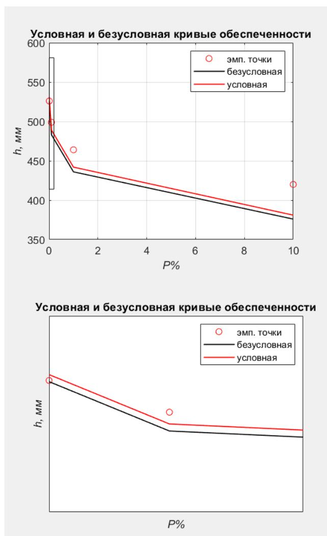
Рисунок 4.7 – Условная и безусловная кривые обеспеченности р. Ижма – с. Усть-Ухта.
