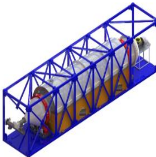
Рис. 26. Установка пиролиза УТД-2 на базе вращающегося реактора [41]
