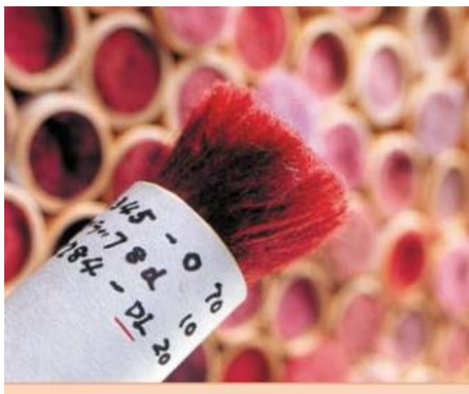
Рис. 30. Образец ковра, имеющий дефект не полной окраски [41]
