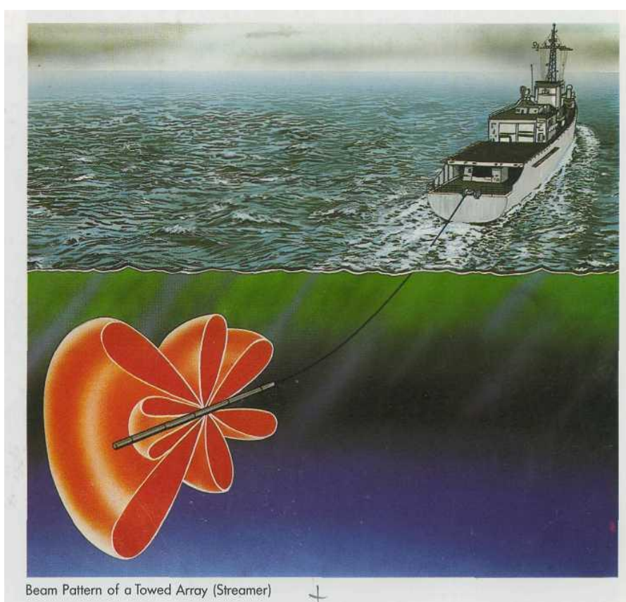
Рисунок 28 - Пространственная диаграмма направленности ГПБА шумопеленгаторной ГАС TAS (ВМС Германии)
