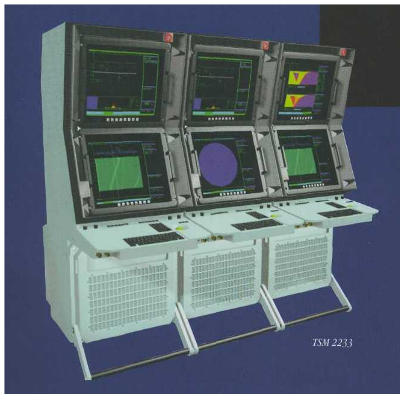
Рисунок 21 - Типовая система отображения информации ГАС с ПА ВМС Великобритании
