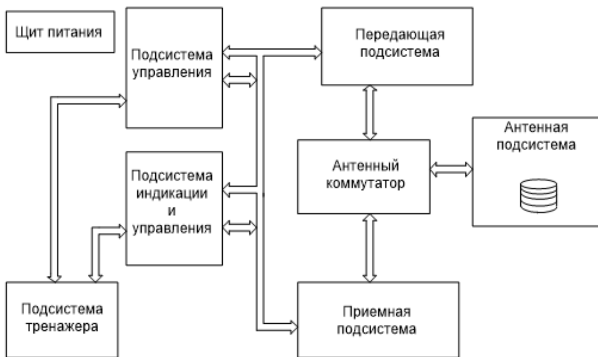
Рисунок 19 - Структура ГАС AN/SQS-56.
