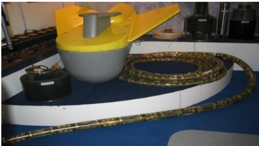
Рисунок 36 - Элементы буксируемой части ГАС «Виньетка-ЭМ»: слева - излучатель; в центре – заглубитель, справа – отрезок ГПБА.
