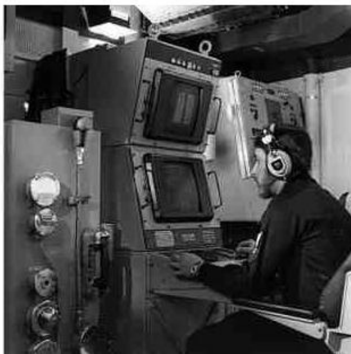
Рисунок 20 - Пультовой прибор ГАС (режиме эхо- и шумопеленгования) AN/SQS-56
