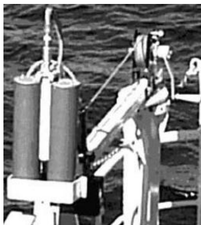
Рисунок 3 – Дистанционный обнаружитель нефти
