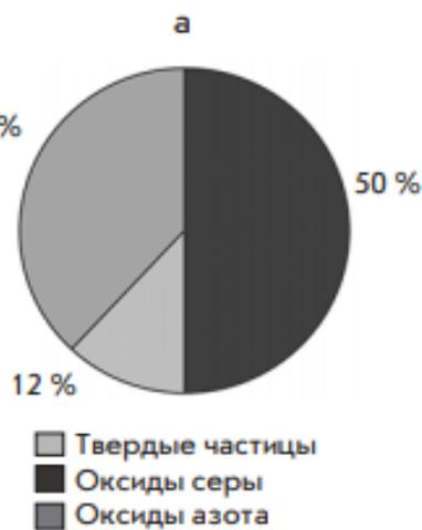
Рисунок 2.4 - Ингредиентная структура выбросов от объектов по производству электрической и тепловой энергии: а - ТЭС, б - ТЭЦ и котельных
