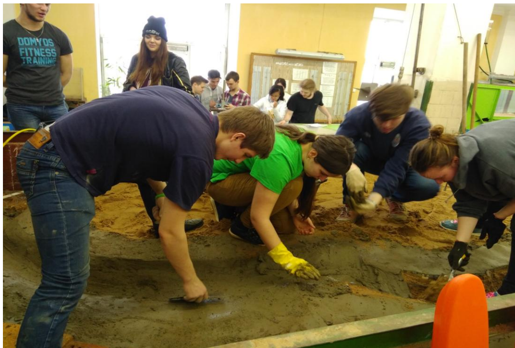
Рисунок 3.13 Закрепление поперечных профилей в моделируемом русле.
