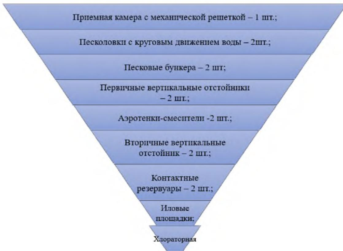
Рисунок 2.2 – Состав очистных сооружений
