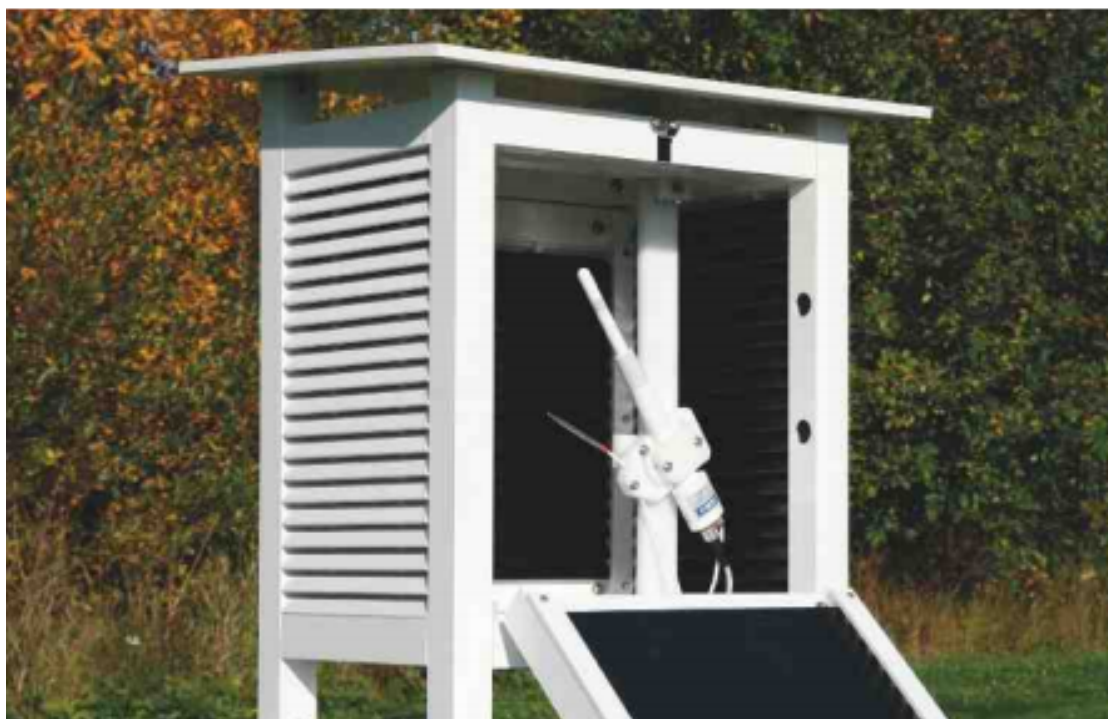
Рисунок 1.1 — Датчик Vaisala HUMICAP® 155
