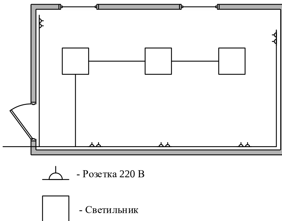
Рисунок 4 – Схема электропитания помещения № 2156
