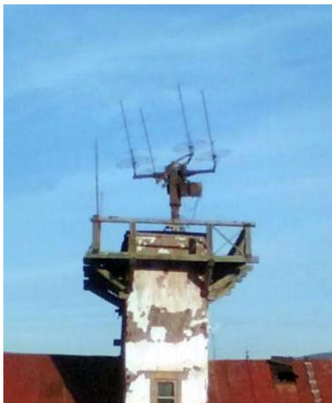
Рисунок 1.2 – Антенна системы зондирования «Малахит».
