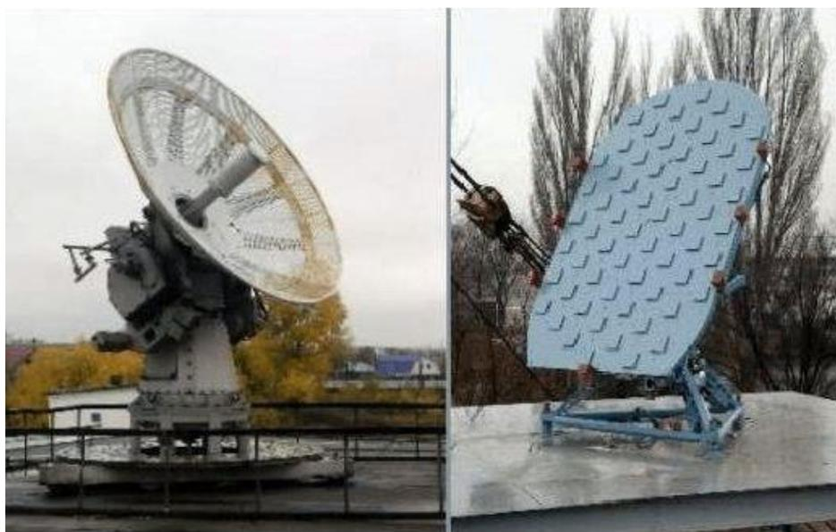
Рисунок 1.3 – Общий вид антенн РЛС АВК-1 и МАРЛ-А.
