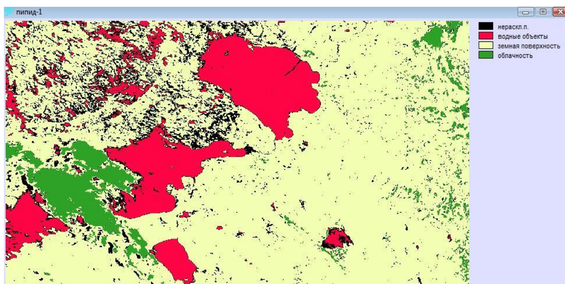
Рис. 4.25 - Классификация RPPID с использованием метода Z-Score
