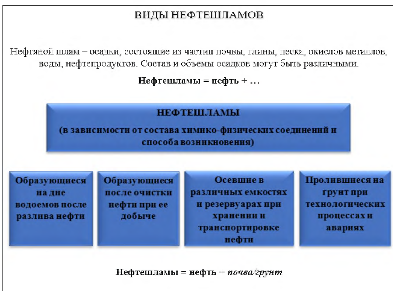
Рисунок 1.1 — Виды нефтешламов и их образование[11, с.87]
