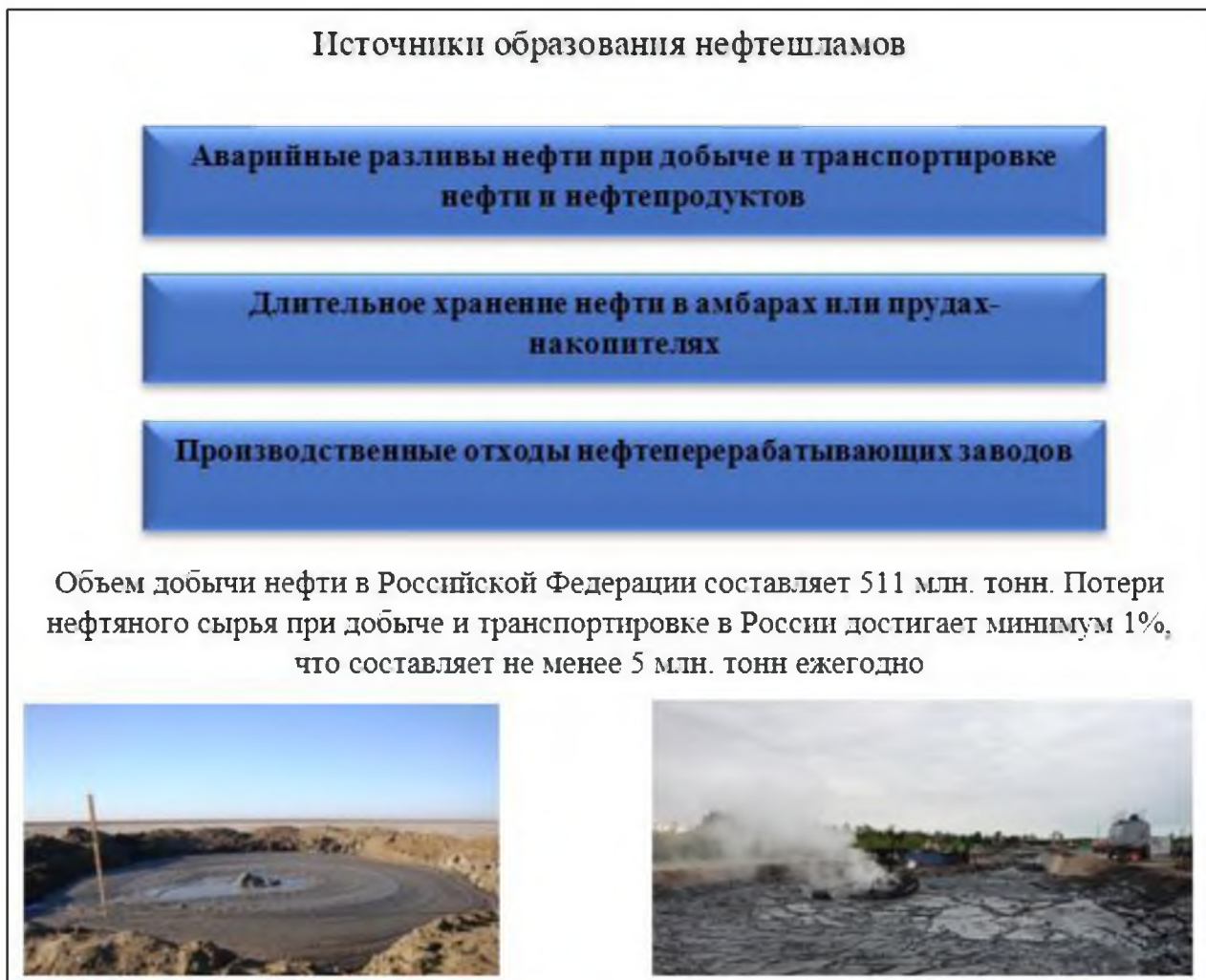
Рисунок 1.3 — Источники образования нефтешлама[17, с.113]
