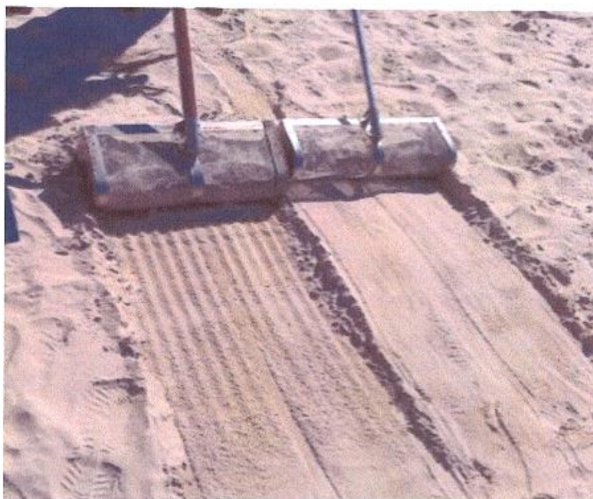
Рисунок 9 - Специальное оборудование (грабли) для применения Rake метода
