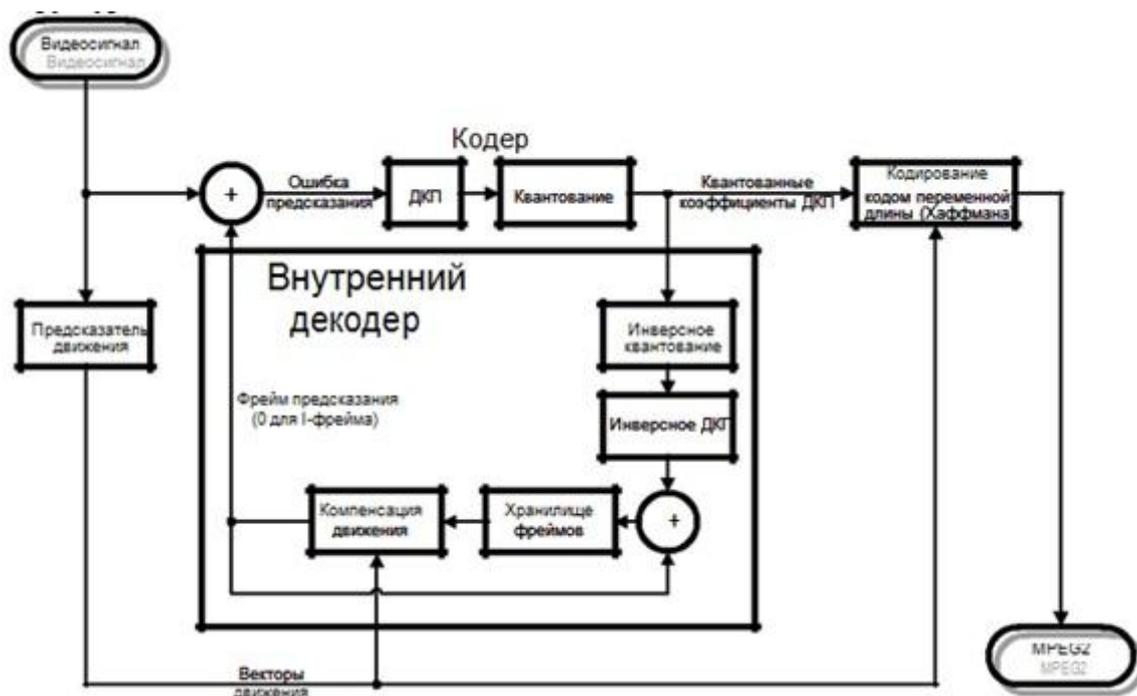
Рисунок 2.8 - Блок схема видеокодера MPEG2
