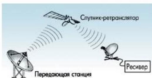
Рисунок 1.6 - Основные элементы системы спутникового телевидения
