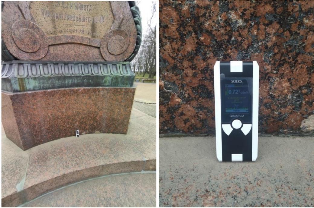
Рисунок 4.6 – Показания дозиметра-радиометра в положении «у земли» возле памятника Петру Первому (Станция № 20).
