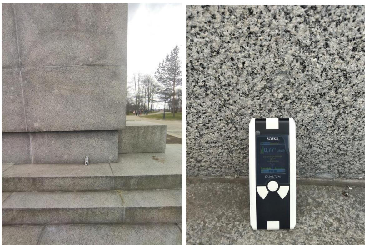
Рисунок 4.5 – Показания дозиметра-радиометра в положении «у земли» возле памятника «Морякам-подводникам» (Станция № 16).
