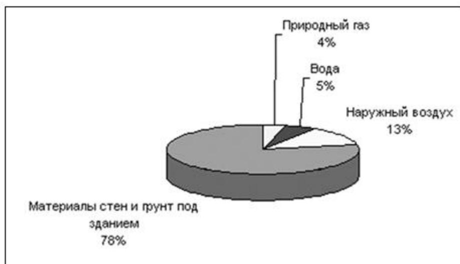
Рисунок 2.3 – Диаграмма процентного содержания радона, при излучении от различных источников. [13]
