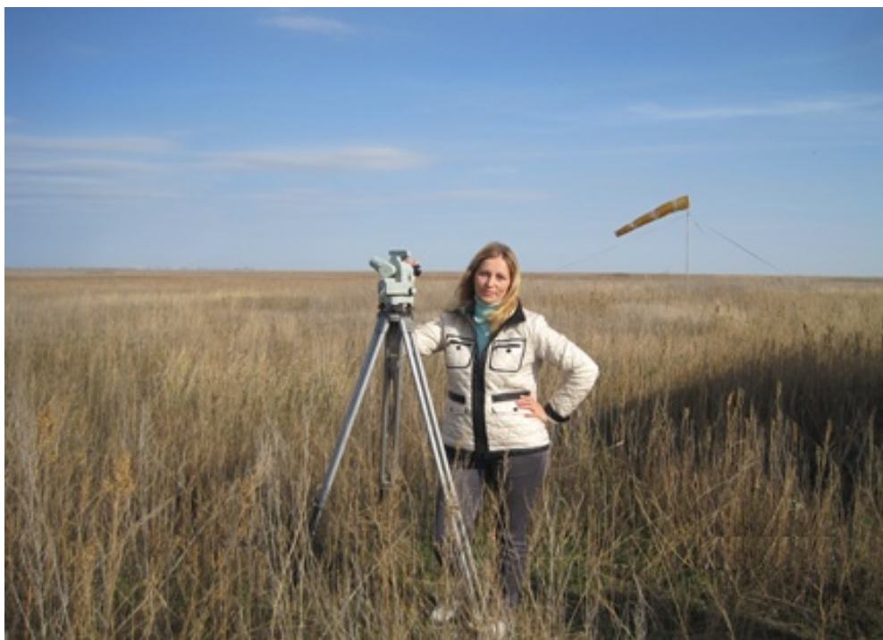
Рисунок 1.3.1. Наблюдения с помощью аэрологического теодолита
