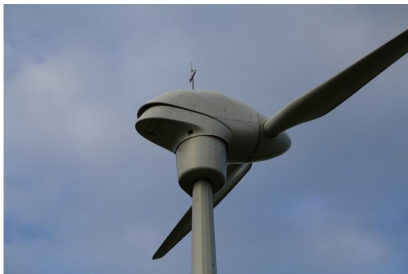
Рисунок 8. Двухлопастная ветроэнергетическая установка Gev MP номинальной мощностью 275 кВт французской фирмы Vergnet S.A
