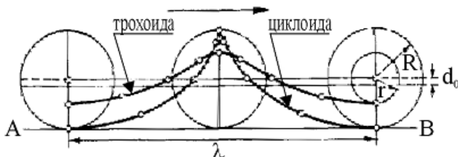
Рисунок 2.2.1.2 Трохоида и циклоида [4]
