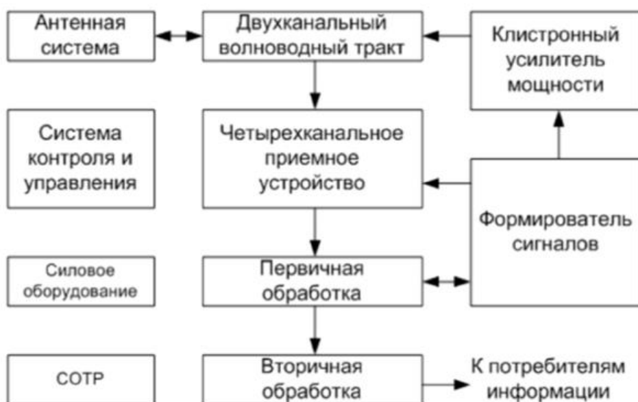
Рисунок 2 - Упрощенная структурная схема ДМРЛ-С [11]
