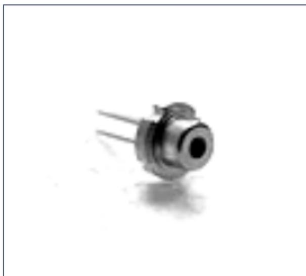
Рисунок 1.5 – Лазерный диод
