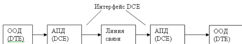
Рис. 4.3.1. Типовая схема организации связи при помощи модемов
