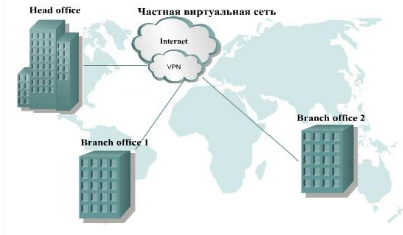
Рис. 6.2.3. Вариант организации локальной сети компании с двумя филиалами с использованием VPN [7]
