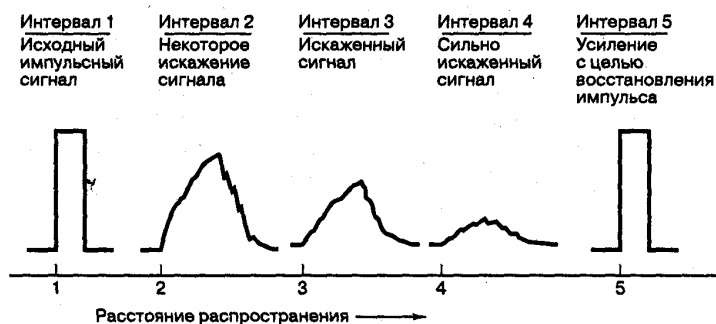
Рис. 1.1. Передача цифрового импульса по каналу связи [2]
