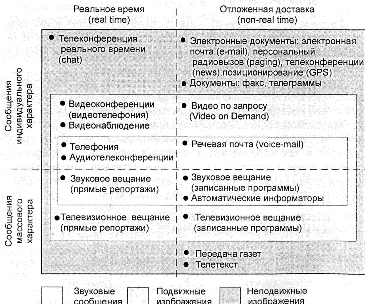
Рис. 1.3. Классификация видов электросвязи по критерию реального времени и отложенной доставки [1]
