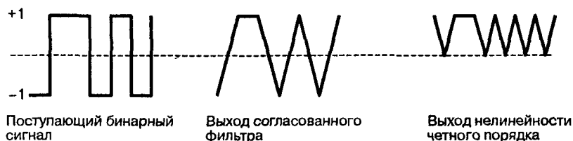
Рис. 3.5.5. Иллюстрация процессов, происходящих в разомкнутом битовом синхронизаторе [2]
