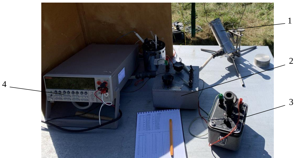
Рисунок 9 – Общий вид пиргелиометра М-59 и его измерительной системы:
