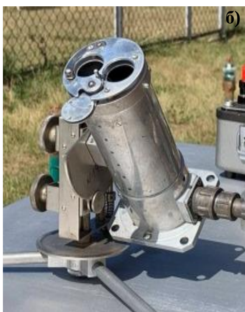
Рисунок 5 – Пиргелиометры из состава вторичного эталона единицы ЭОСИ: а) РМО6 №0817, установленный на систему слежения за солнцем; б) М-59 №14; в) М-59 №15
