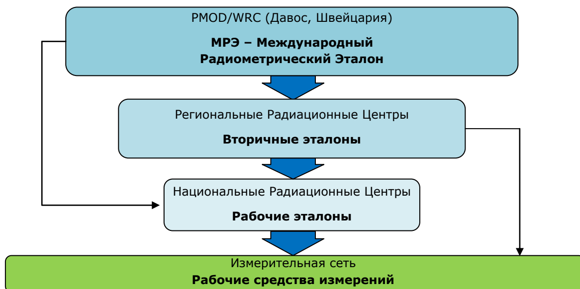
Рисунок 3 – Схема международного метрологического обеспечения приземных измерений солнечной радиации
