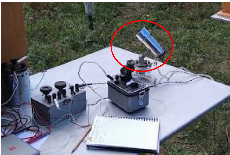
Рисунок 6 – Пиргелиометр Ангстрема № 212 со вспомогательным оборудованием при ежегодных сравнениях в г. Кисловодск
