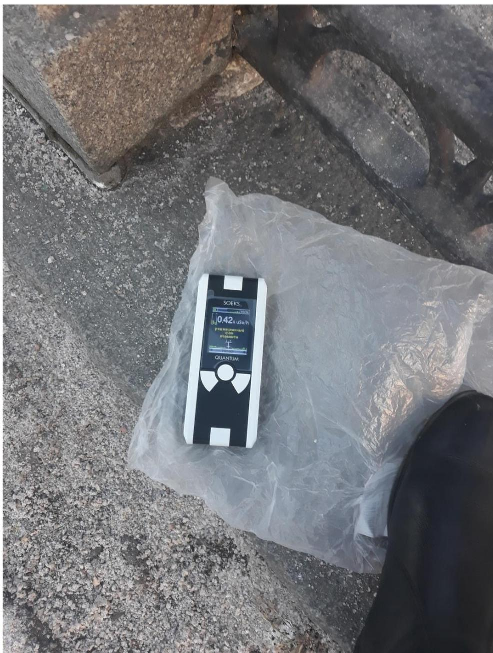
Рисунок 3.2 – Измерение гамма-излучения на граните дозиметром Соекс Кантум на набережной Обводного канала
