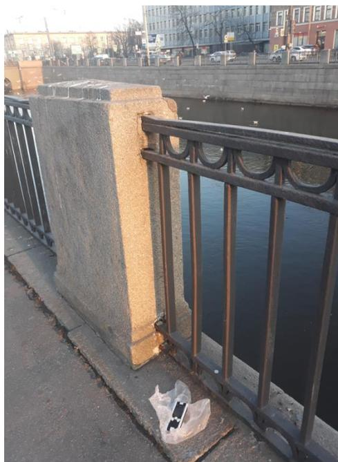
Рисунок 3.1 – Измерение гамма-излучения на граните дозиметром Соекс Кантум на набережной Обводного канала
