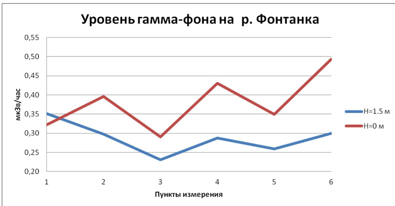
Рисунок 3.8 — График изменения уровня излучения на высоте 0 и 1.5 метров на набережной р. Фонтанки
