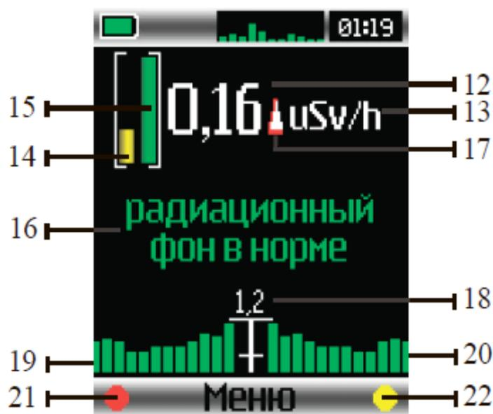
Рисунок 3.6 – Дисплей дозиметра «Соекс-Кантум» в режиме «Измерение»
