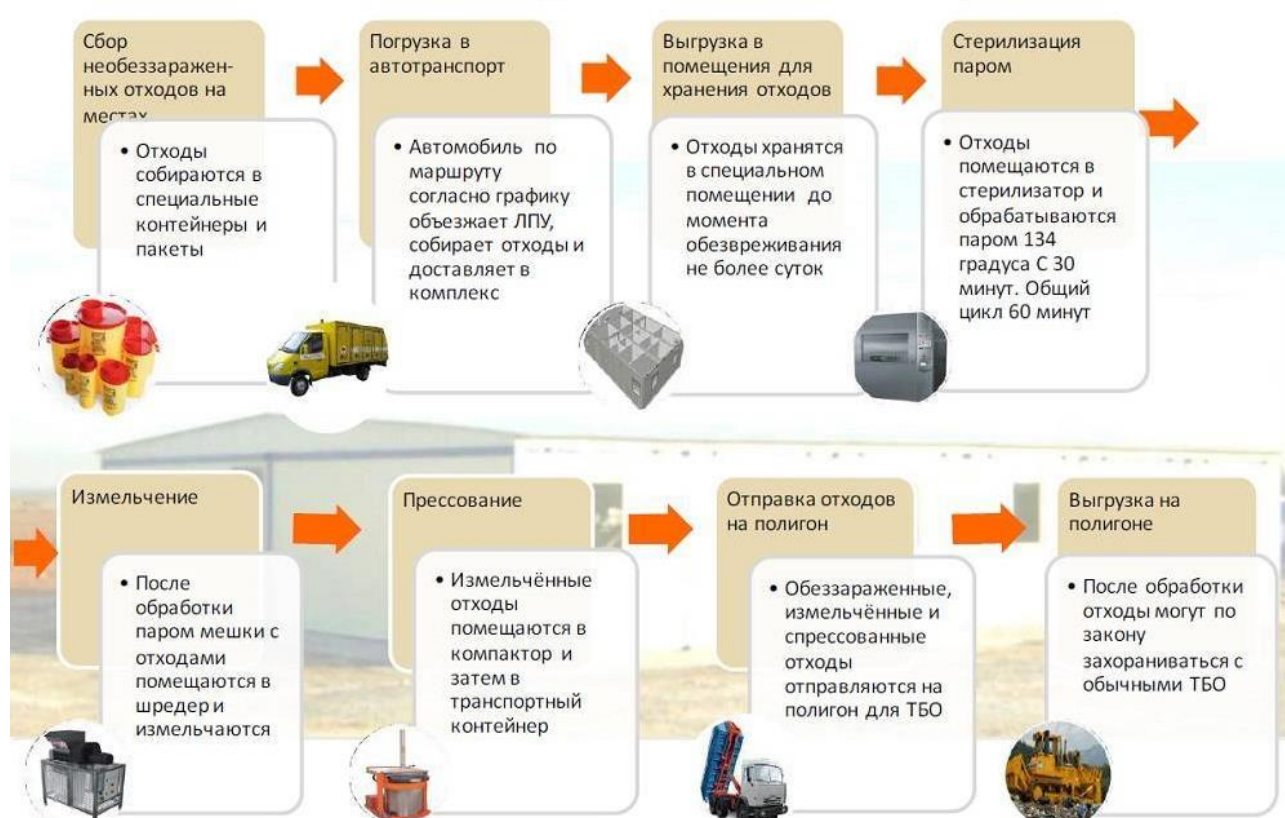
Рисунок 23 – Примерная схема № 1 для ЛПУ
