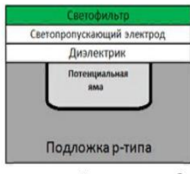
Рисунок 2 - Схема устройства пикселя
