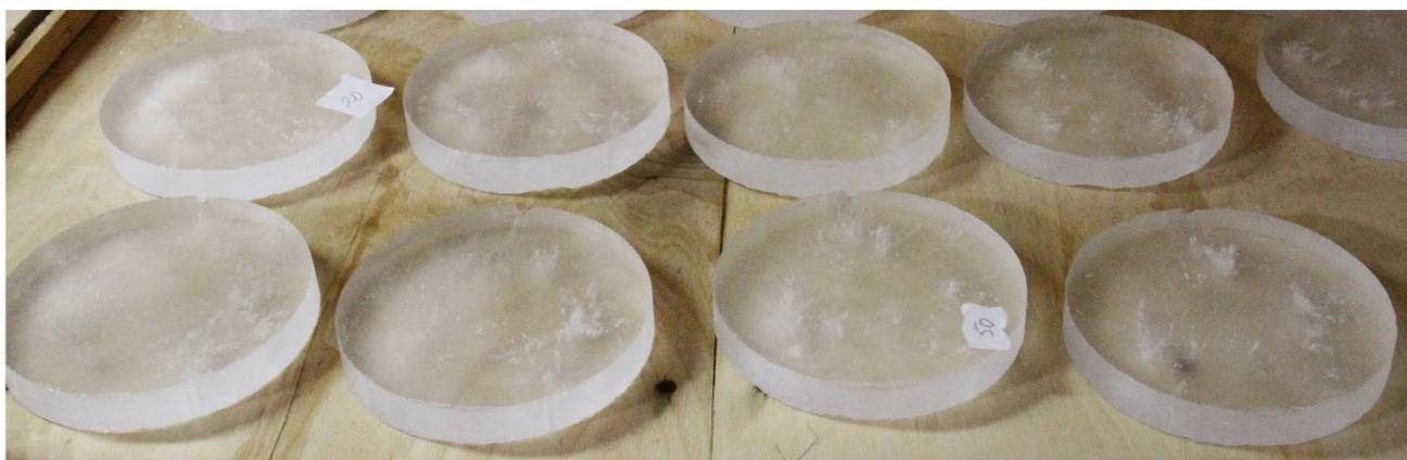
Рис.5 Распиловка керна на пластины
