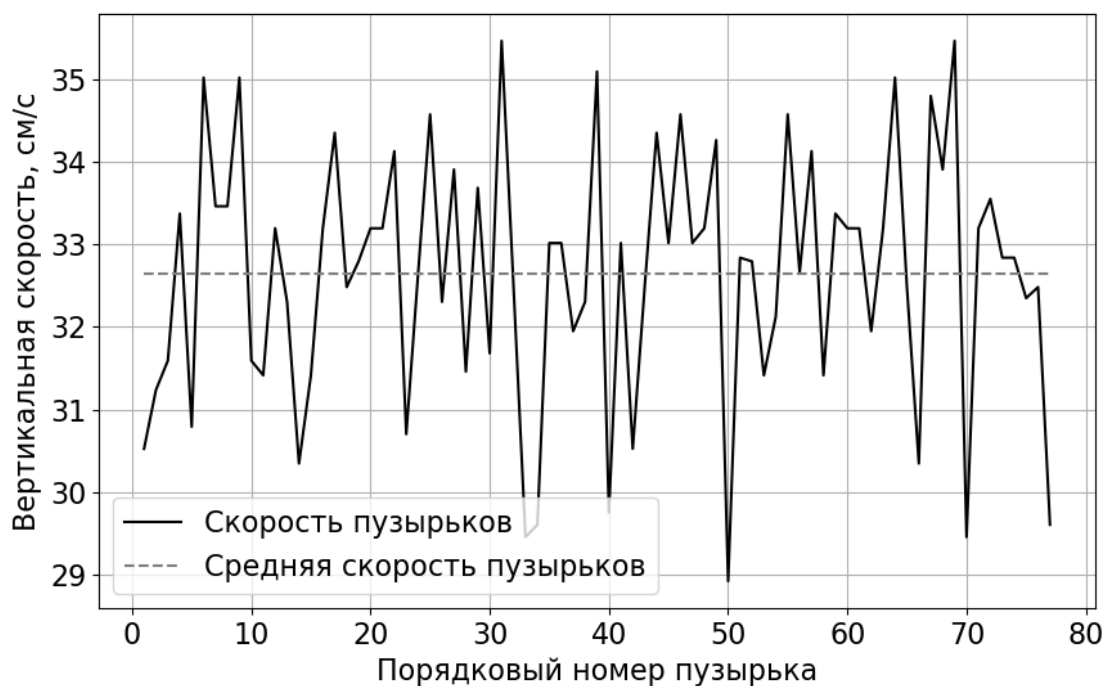
Рисунок 3.10 Измеренные вертикальные скорости пузырьков. Q = 0,5 мл/с
