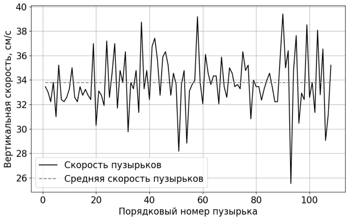
Рисунок 3.13 Измеренные вертикальные скорости пузырьков. Q = 0,65 мл/с
