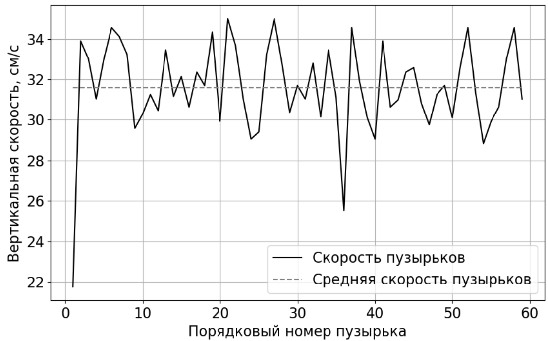
Рисунок 3.4 Измеренные вертикальные скорости пузырьков. Q = 0,3 мл/с
