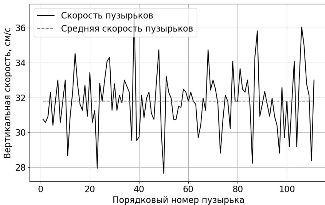
Рисунок 3.7 Измеренные вертикальные скорости пузырьков. Q = 0,4 мл/с
