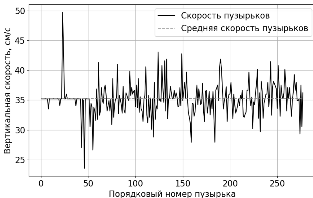
Рисунок 3.15 Измеренные вертикальные скорости пузырьков. Q = 1 мл/с
