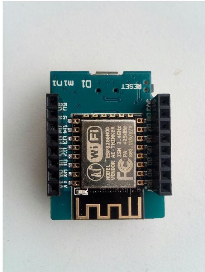
Рисунок 2.4 — Внешний вид платформы Wemos D1 mini
