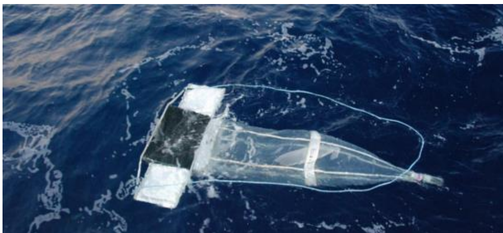
Рисунок 1.1 – Буксируемая сеть “манта” для взятия проб микропластика с поверхности воды [14].
