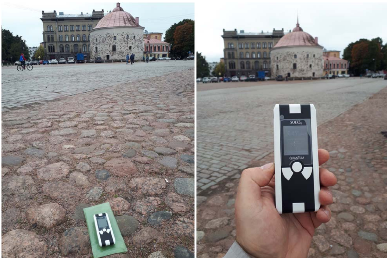
Рисунок 3.7 – Показания дозиметра-радиометра в положении «у поверхности земли» (слева) и на расстоянии 1,5 м от гранитной брусчатки, Станция №6
