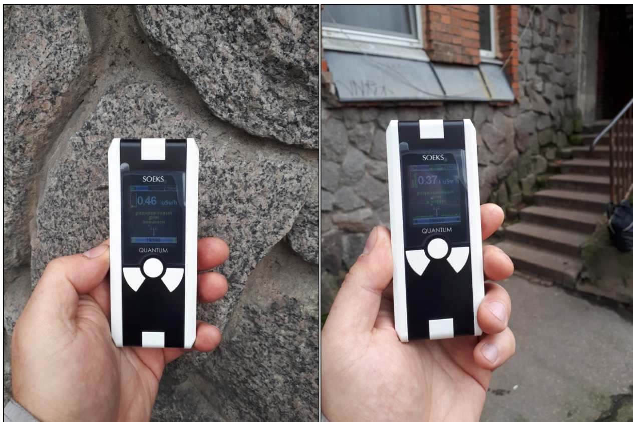
Рисунок 3.2 – Показания дозиметра-радиометра в положении «у стены» (слева) и на расстоянии 1,5 м от стены из гранита, Станция №12
