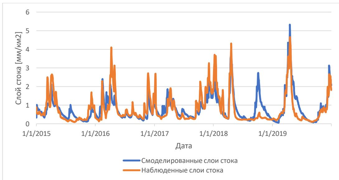
Рисунок 6.1 – График калибровки модели на реке Селезневка
