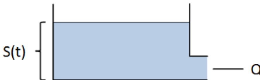
Рисунок 5.2 – Схема работы блока ответной функции модели HBV
