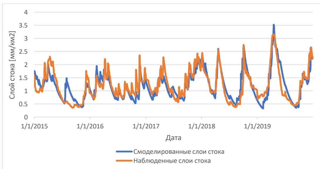
Рисунок 6.2 – График калибровки модели на реке Гороховка
