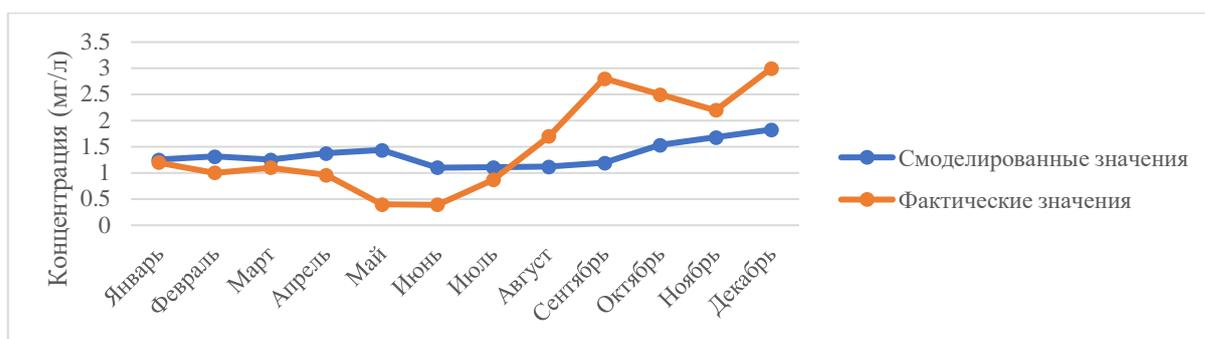
Рисунок 7.11 – График-сравнение смоделированных концентраций азота и фактически измеренных на реке Шингарка
