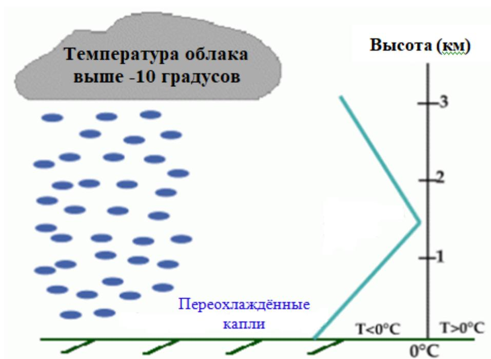
Рисунок 1.6.5 - Распределение температуры при осадках в виде «теплого» замерзающего дождя
