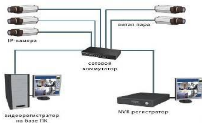
Рис. 9 – Схема подключения устройств.
