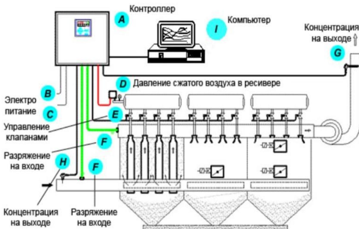
Схема отчистки загрязненного воздуха рукавного фильтра ФРИ-630
