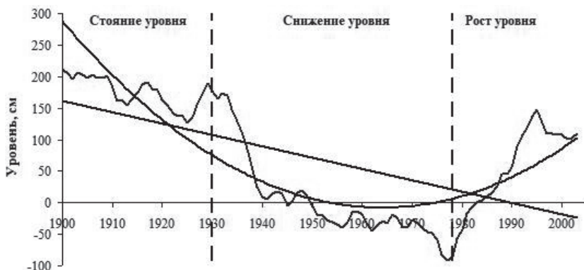
Рис. 10.5. Межгодовой ход уровня Каспийского моря по инструментальным наблюдениям (за нуль принята отметка –28 м БС)
