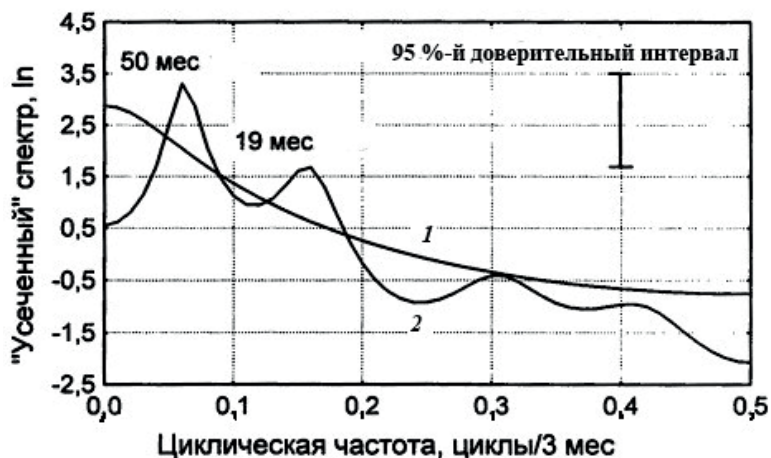
Рис. 11.8. МНЭ-оценки спектральной плотности для временного ряда среднемесячных аномалий температуры поверхности океана с разрешением 3 месяца. Кривая 1 соответствует модели авторегрессии 1-го порядка («красный шум»), кривая 2 – модели 8-го порядка
