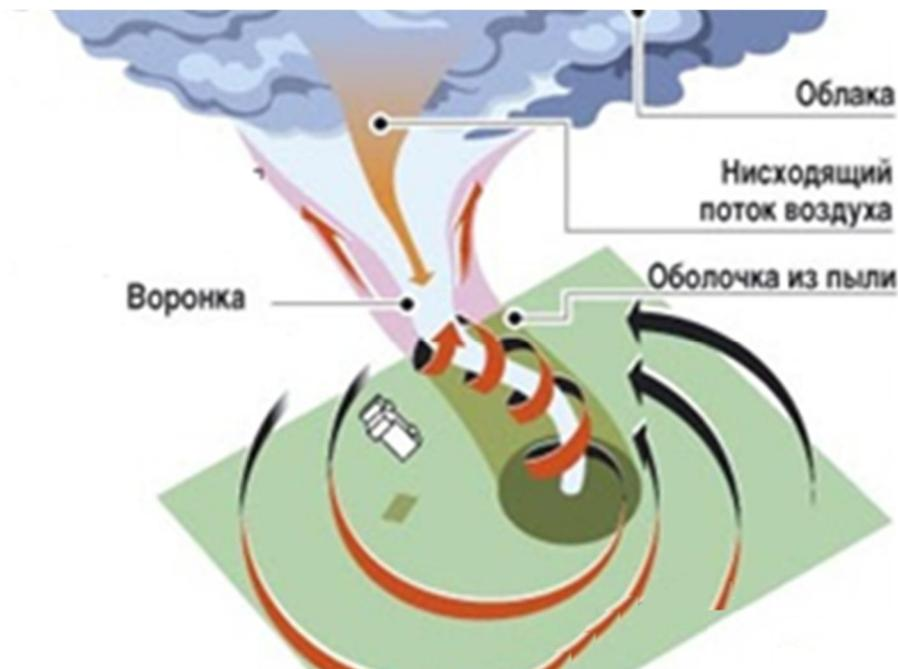
Рисунок 8 – Схема строения торнадо
